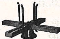
afwikkellapparaat A 61 820 mm ø, 300 kg
